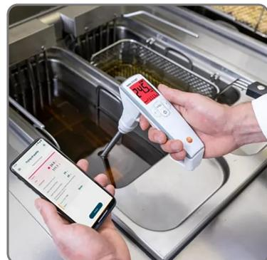
Die häufige Verwendung desselben Öls kann die Qualität des Produkts beeinträchtigen und zu Kundenbeschwerden führen. Hauptbestandteil des Frittieröltesters Testo 270 ist der neue kapazitive Sensor von Testo, der die direkte Messung der TPM-Menge im heißen Öl ermöglicht. Testo 270 misst während der Produktion in mehreren Friteusen nacheinander, ohne dass der Sensor abkühlen muss. Testo 270 ermöglicht eine maximale Ausnutzung des Öls, das nur bei Überschreitung des Grenzwerts ausgetauscht wird.
